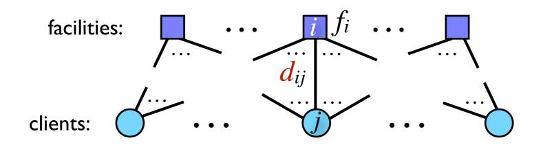
$$\begin{aligned} & \min & \sum_{i \in F, j \in C} d_{ij} x_{ij} + \sum_{i \in F} f_i y_i \\ & \text{s.t.} & y_i - x_{ij} \geq 0, \qquad \forall i \in F, j \in C \\ & \sum x_{ij} \geq 1, \qquad \forall j \in C \end{aligned}$$
