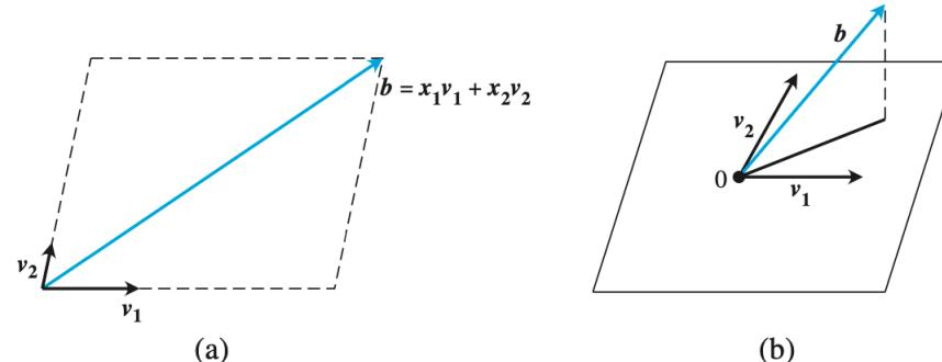
最接近的点记为 $A\bar{x}$ ，则 $(A\bar{x} - b) \perp \{A x: x \in R^n\}$
